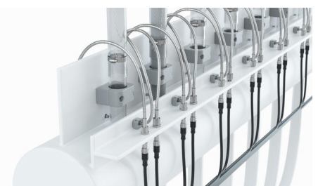
An den Glasröhrchen am Rücklauf der KTL mussten insgesamt 312 metallummantelte Glasfaserlichtleiter installiert werden, die auf die einzelnen Sender und Empfänger aufgesetzt wurden.
