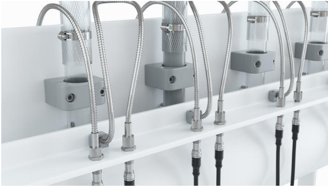
Wird der Infrarotlichtstrahl der Lichtschranke, bestehend aus einem optischen Sender OS126020 und einem optischen Empfänger OE126020 , aufgrund einer Eintrübung der Kühlflüssigkeit in einem der Glasröhrchen unterbrochen (zweites Röhrchen von Links), erzeugt der betreffende Auswertekanal der Anschlusseinheit ein Schaltsignal.
