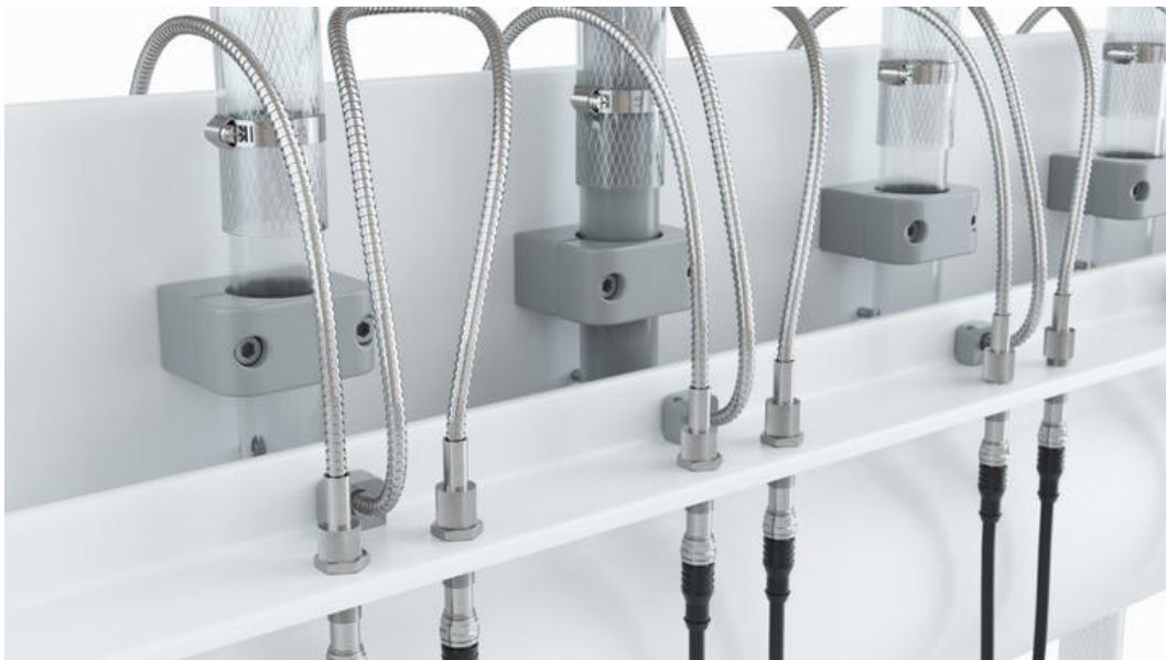
Si le faisceau de lumière infrarouge de la cellule photoélectrique, composée d'un émetteur optique OS126020 et d'un récepteur optique OE126020Si le signal est interrompu en raison d'une opacification du liquide de refroidissement dans l'un des tubes en verre (deuxième tube en partant de la gauche), le canal d'évaluation correspondant de l'unité de branchement génère un signal de commutation.
