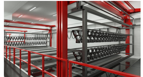
L'intero processo di rivestimento catodico per immersione richiede un totale di 12 singole fasi di processo e consiste in diverse vasche di grande volume disposte una dietro l'altra. (Tutte le immagini: ipf electronic gmbh)
