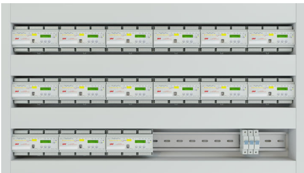
插入式发射器和接收器元件通过传统的传感器电缆与 20 个评估单元相连，评估单元位于一个单独的控制柜中。放大器可手动和自动调节发射功率（用于高污染补偿）。
