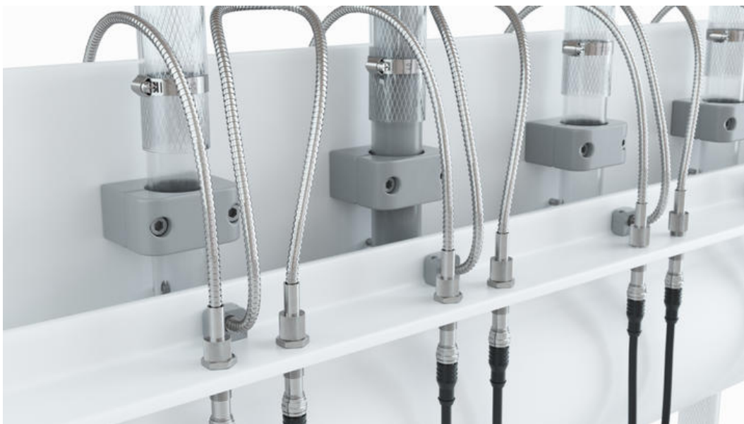
如果光屏障的红外光束由光学发射器组成 OS126020 和光学接收器 OE126020 如果其中一根玻璃管（左起第二根管）中的冷却液混浊导致红外光束中断，连接装置的相关评估通道将发出切换信号。
