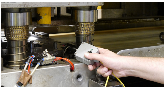
Snímač lze velmi snadno naučit zvenčí prostřednictvím Teachboxu, aniž by bylo nutné manipulovat se samotným snímačem.
