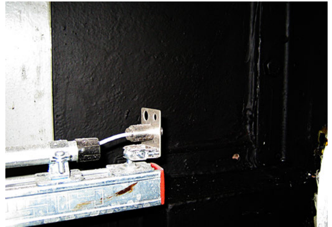
ipf_FHW_Neukoelln004 und ipf_FHW_Neukoelln005: Detailaufnahme des Messkopfes, der auf dem vorderen Bereich eines Aluminiumprofils befestigt wurde und sich bei Umgebungstemperaturen von bis zu +180°C ohne Kühlung einsetzen lässt.
