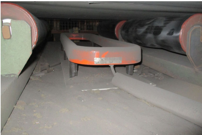
Die Detektorspule unter dem Förderband ist mit PVC-Säulen auf einer Aluminiumgrundplatte montiert, die gegen elektromagnetische Störungen der Unterbaukonstruktion abschirmt. Dieses Konzept gewährleistet außerdem eine sehr stabile Montage.
