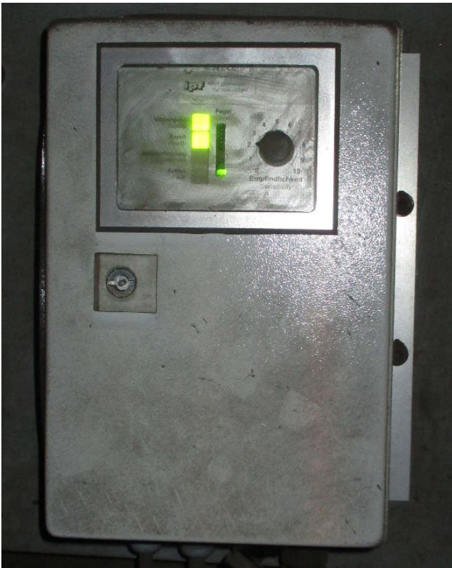
Über die Auswerteeinheit kann das Ansprechverhalten der Detektorspule eingestellt werden.
