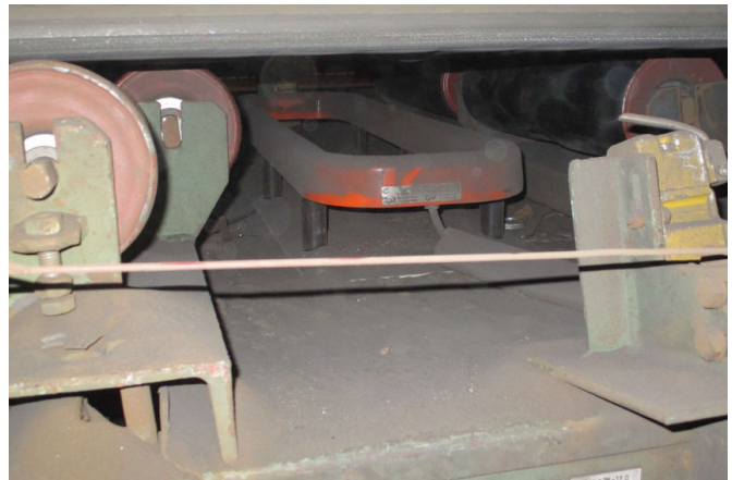
Die Detektorspule unter dem Förderband ist mit PVC-Säulen auf einer Aluminiumgrundplatte montiert, die gegen elektromagnetische Störungen der Unterbaukonstruktion abschirmt. Dieses Konzept gewährleistet außerdem eine sehr stabile Montage.
