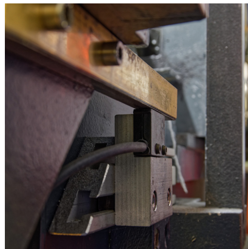
Der Sensor MW110430 ist an der Maschine montiert, damit das Anschlusskabel keinem Verschleiß unterliegt. Oberhalb des Sensors befindet sich das am Vortrieb befestigte und durch ein zusätzliches Edelstahlband vor Verschmutzung geschützte Magnetband. (Bild: ipf electronic)
