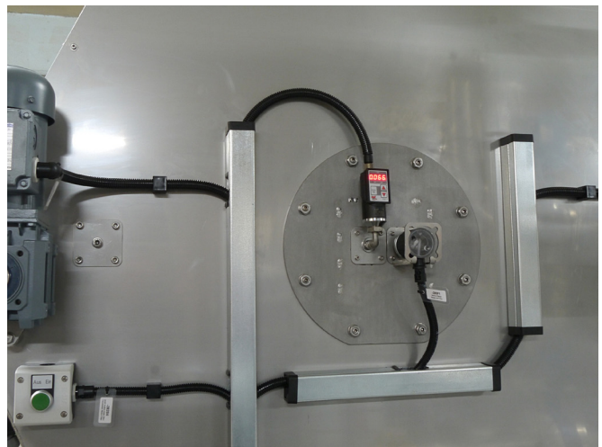
Detailaufnahme des Drucksensors zur Füllstandskontrolle oberhalb des Filtervlieses.
