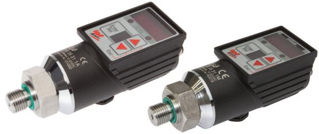
Die baugleichen Drucksensoren DW35311A (links) und DW35331M arbeiten im Millibarbereich und liefern daher die hohe Auflösung bzw. exakten Ausgangssignale, die für die Umhebestationen sowie Saubertanks mit vergleichsweise geringer Füllstandshöhe notwendig sind.
