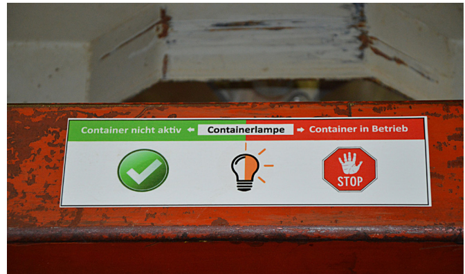
Missverständnisse ausgeschlossen: Ein zusätzlicher Hinweis oberhalb der LED-Leuchten erklärt die Bedeutung der Lichtsignale.
