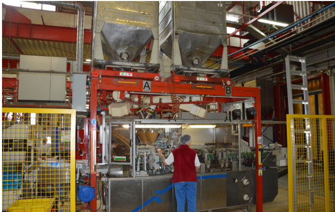
Das Bedienpersonal an den Abfüllanlagen erhält eine Meldung, sobald ein Rohmaterialbehälter oberhalb der Abfüllstation leer ist. Dann wird die Anlage auf den zweiten, vollen Behälter umgeschaltet und ein Staplerfahrer angefordert, der das Leergebinde austauscht. (alle Bilder: ipf electronic)
