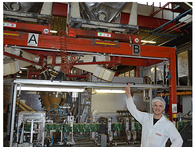
Rudolf Kau zeigt, wie die Signal-Lösung in das Gesamtkonzept der Abfüllanlage integriert wurde. Die kompakten LED-Leuchten behindern weder beim Rangieren des Staplers, noch können sie unbeabsichtigt durch eine Staplergabel beschädigt werden.
