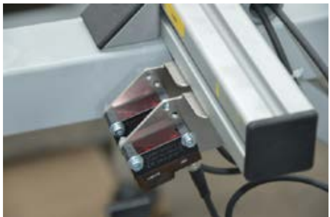
Bezdotykově pracující optické senzory řady OT43 disponují maximálním snímáním rozsahem 600 mm. Přístroje se stupněm krytí IP67 jsou v zařízení namontovány tak, aby byly relativně necitlivé vůči znečištění.
