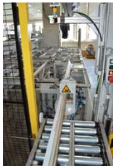
Pro rozpoznávání typů profilů se používá kamerový senzor OC539621 (nahore uprostřed obrázku) v kombinaci s čárovým laserovým ukazatelem PP98C893 (vlevo od kamerového senzoru). Oba přístroje byly namontovány na speciálním přípravku, aby snímaly profily shora.
