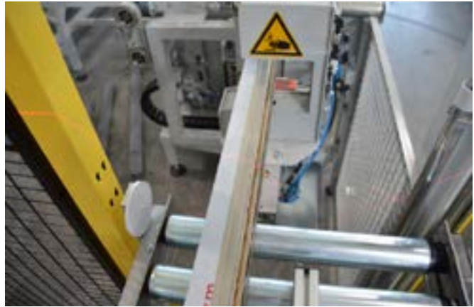
Kontrola typů profilů se provádí na válečkovém dopravníku. Zde se okenní profily, zhotovené již předem v jiné stroji, automaticky předávají do zařízení.
