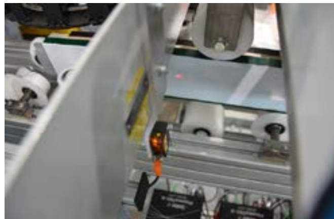
Ohledně přesné detekce přední hrany profilu se firma Lechenauer rozhodla pro laserové světelné snímače PT430470 , které generují velice přesný laserový bod pro spouštěcí signál.
