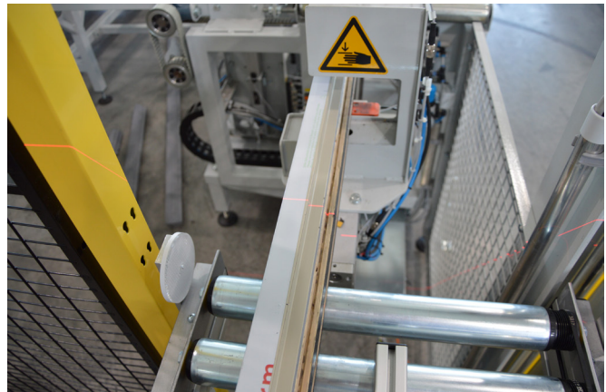
Die Prüfung der Profiltypen erfolgt an einer Rollenbahn. Dort werden die in einer anderen Maschine bereits vorgefertigten Fensterprofile automatisch an die Anlage übergeben.
