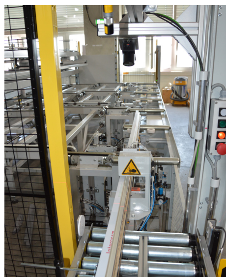
Für die Profiltypenerkennung wird ein Kamerasensor OC539621 (oben, Bildmitte) in Kombination mit einem Linienlaserpointer PP98C893 (links vom Kamerasensor) verwendet. Beide Geräte wurden an einer speziellen Vorrichtung montiert, um die Profile von oben zu erfassen.
