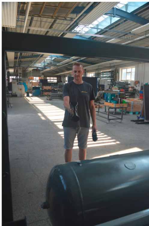
Konstruktér Wolfgang Zorn kontroluje netěsnosti vakuové nádoby membránového lisu pomocí akustické nálevky detektoru netěsností.
