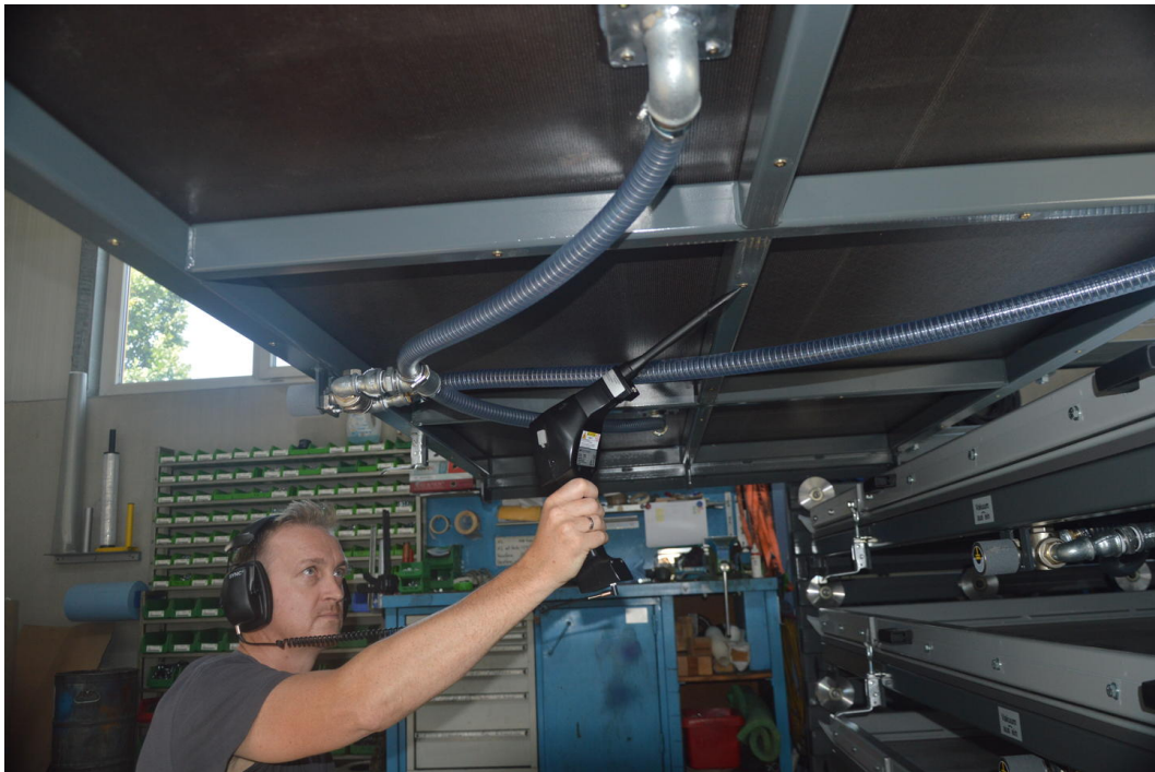
Avec le réducteur de bruit et l'écouteur pour le UY000003 d'IPF permettent de localiser les moindres pertes de vide sous la table à vide, comme ici sur un raccord à vis. On estime que jusqu'à 100 points de contrôle doivent être contrôlés sur la machine.
