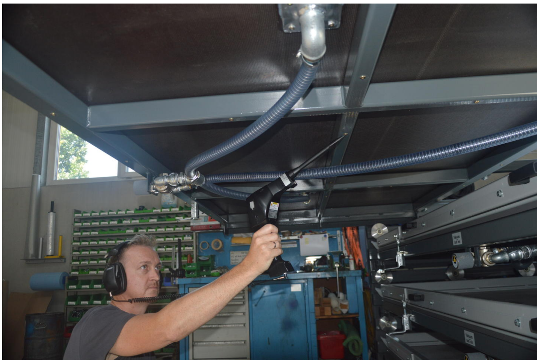
Con il riduttore di suono e le cuffie per l'apparecchio UY000003 di IPF è possibile individuare le minime perdite di vuoto sotto la tavola del vuoto, come mostrato qui su un collegamento a vite. Si stima che sulla macchina debbano essere controllati fino a 100 punti di prova.
