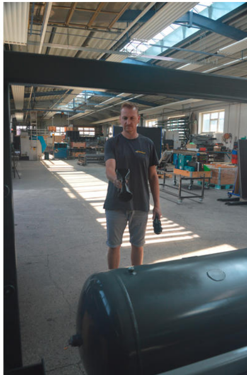
L'ingegnere progettista Wolfgang Zorn controlla che il recipiente sottovuoto della pressa a membrana non presenti perdite utilizzando l'imbuto acustico del rilevatore di perdite.
