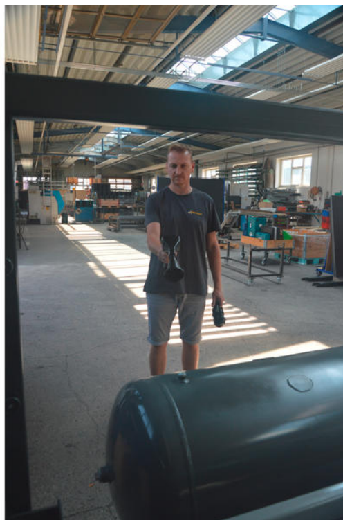
Inżynier projektowy Wolfgang Zorn sprawdza zbiornik próżniowy prasy membranowej pod kątem nieszczelności za pomocą lejka akustycznego detektora nieszczelności.
