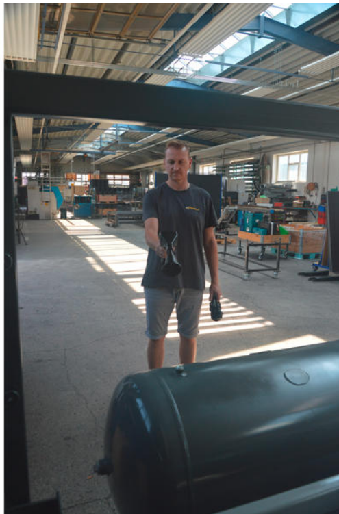
O engenheiro de design Wolfgang Zorn verifica se existem fugas no recipiente de vácuo da prensa de membrana utilizando o funil acústico do detetor de fugas.
