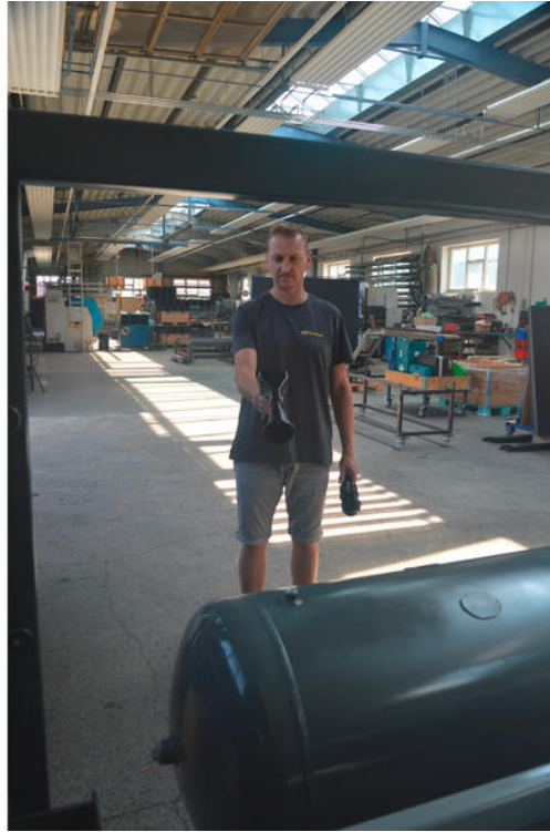
设计工程师 Wolfgang Zorn 使用检漏仪的声漏斗检查膜压机真空容器的泄漏情况。
