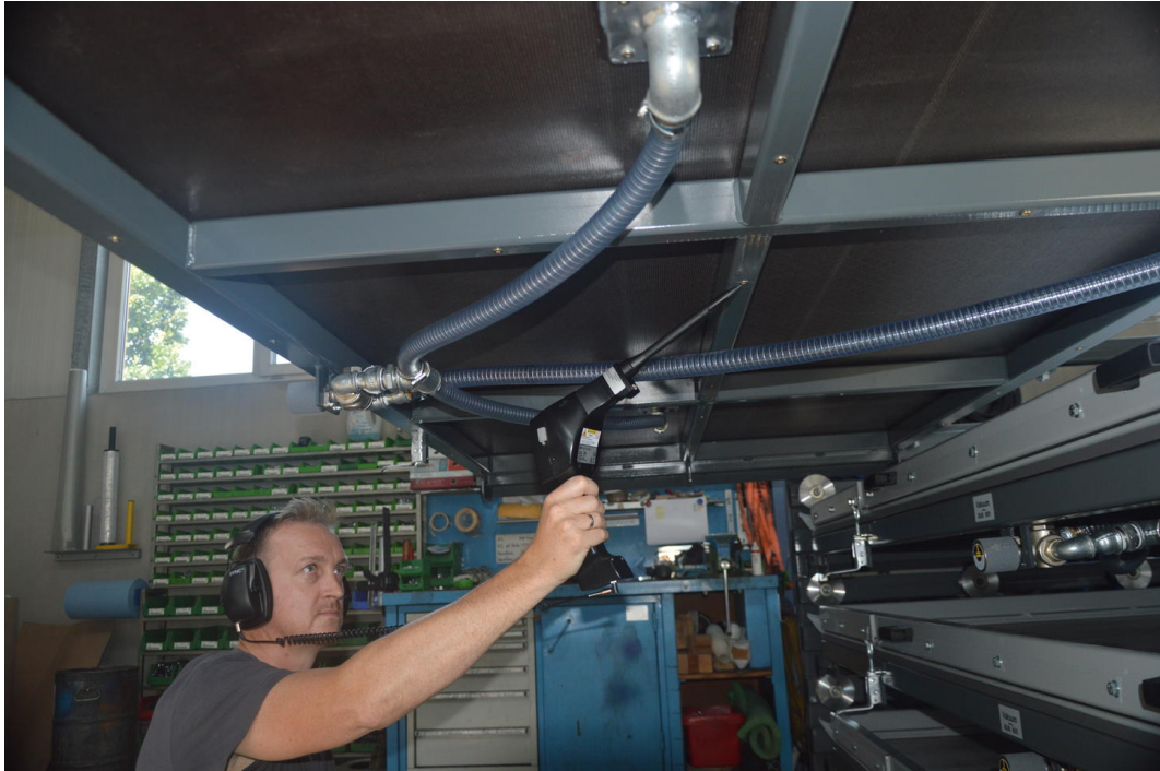
带有减音器和耳机的 UY000003 可用于定位真空表下方最小的真空损耗，如图所示的螺纹连接。据估计，必须在机器上检查多达 100 个测试点。
