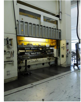
Lis pro výrobu těsnění hlavy válců. Těsnění se zhotovují z běžícího ocelového svitku, přičemž jednotlivé vrstvy vícevrstevných ocelových těsnění (MLS) jsou vyráběny v progresivních maticích, které kombinují několik pracovních kroků.
