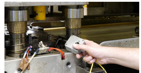
Über eine Teachbox lässt sich der Sensor sehr einfach von außen teachen, ohne das Gerät selbst berühren zu müssen.
