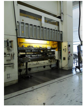
Presna para la fabricación de juntas de culata. La producción tiene lugar a partir de una bobina de acero en marcha, mediante la cual las capas individuales de las juntas de acero multicapa (juntas MLS) se fabrican en moldes progresivos que combinan varios pasos de trabajo.
