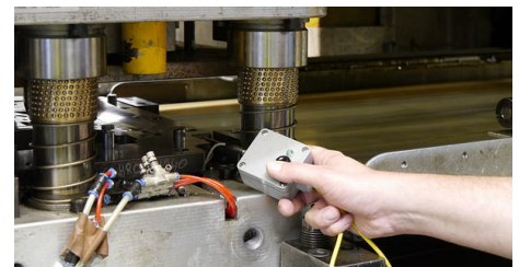
Un boîtier d'apprentissage permet d'apprendre très facilement le capteur de l'extérieur, sans avoir à toucher l'appareil lui-même.
