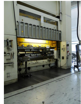
Presse pour la fabrication de joints de culasse. La production s'effectue à partir de bobines d'acier en mouvement, les différentes couches de joints d'étanchéité en acier multicouches (joints MLS) étant fabriquées dans des outils à suivre qui combinent plusieurs étapes de travail.
