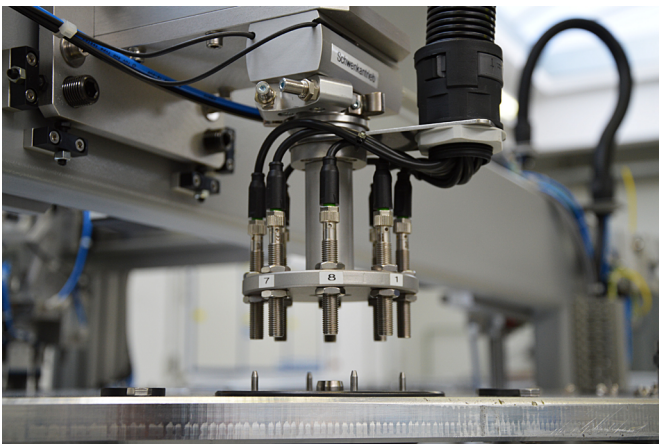
Die Prüfstation verfügt über insgesamt acht Sensoren, wobei sich jeweils ein MC080180 und MC080185 für die Erkennung des Süd- respektive Nordpols abwechseln.
