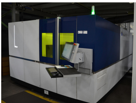
V průběhu investic do nových laserových řezacích systémů, např. TruLaser 5030 fiber od společnosti Trumpf, se společnost Kettenwulf blíže zabývá jejich spotřebou.
