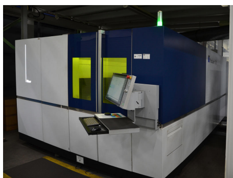
作为投资新型激光切割系统（如通快公司的 TruLaser 5030 光纤切割系统）的一部分，Kettenwulf 正在仔细研究其消耗量。
