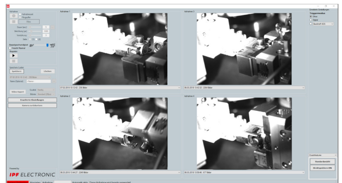
Eine Besonderheit der Software ist die gleichzeitige Darstellung und damit der Vergleich von bis zu vier Aufnahmen. Die Abspielzeitpunkte jeder Aufnahme können hierbei individuell, auch während der Wiedergabe, aufeinander abgestimmt werden.
