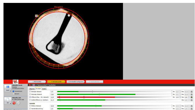
Zusätzlich zur Lage des Verschlusses auf der Flasche erfolgt die Prüfung des Kronkorkens anhand eines vordefinierten Differenzwertes. Hierbei werden die Abstände vom längsten und kürzesten Suchstrahl miteinander verglichen und hieraus die Differenz gebildet, die quasi das Maß für Ovalität des Verschlusses markiert. (Bild: ipf electronic)
