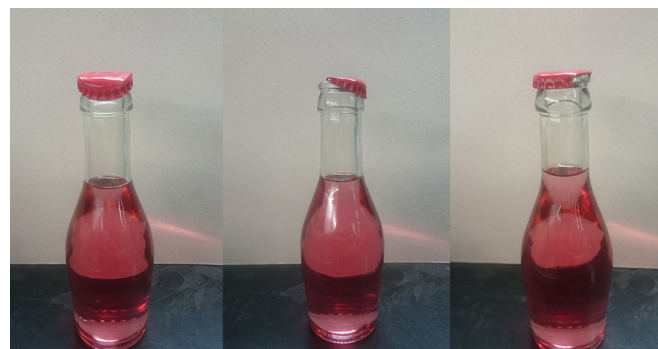
Für Vorversuche zur Verfügung gestellte Flaschen mit defekten Kronkorken. Ganz rechts ein fehlerhafter Verschluss, der weder von oben noch seitlich, je nach Position zum Inspektionssystem, nahezu kaum zu erkennen ist. (Bilder: ipf electronic)
