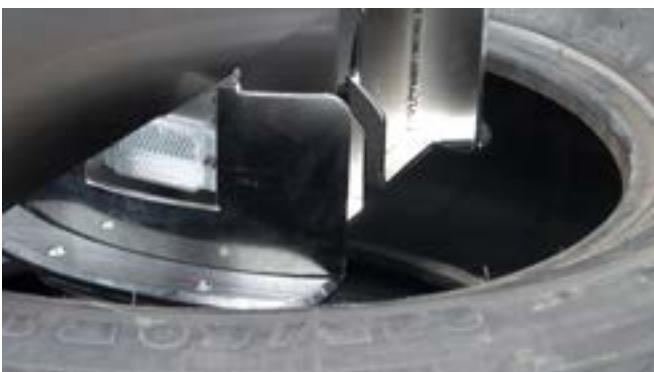
Die Schaltabstände der beiden optischen Taster OT330570 in den Greifern wurden auf die leicht hervorstehenden Reifenauflagen geteacht. Im beweglichen Greifer befindet sich außerdem der Reflektor für die Lichtschranke.
