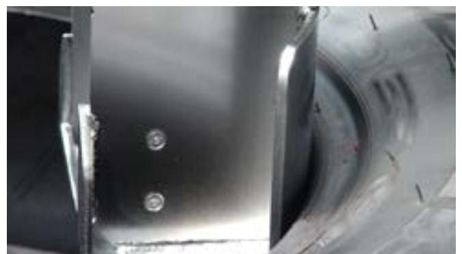
Der Spannvorgang der Greifer stoppt unabhängig vom Reifeninnendurchmesser automatisch, wenn beide Reifenflanken sicher erkannt wurden.
