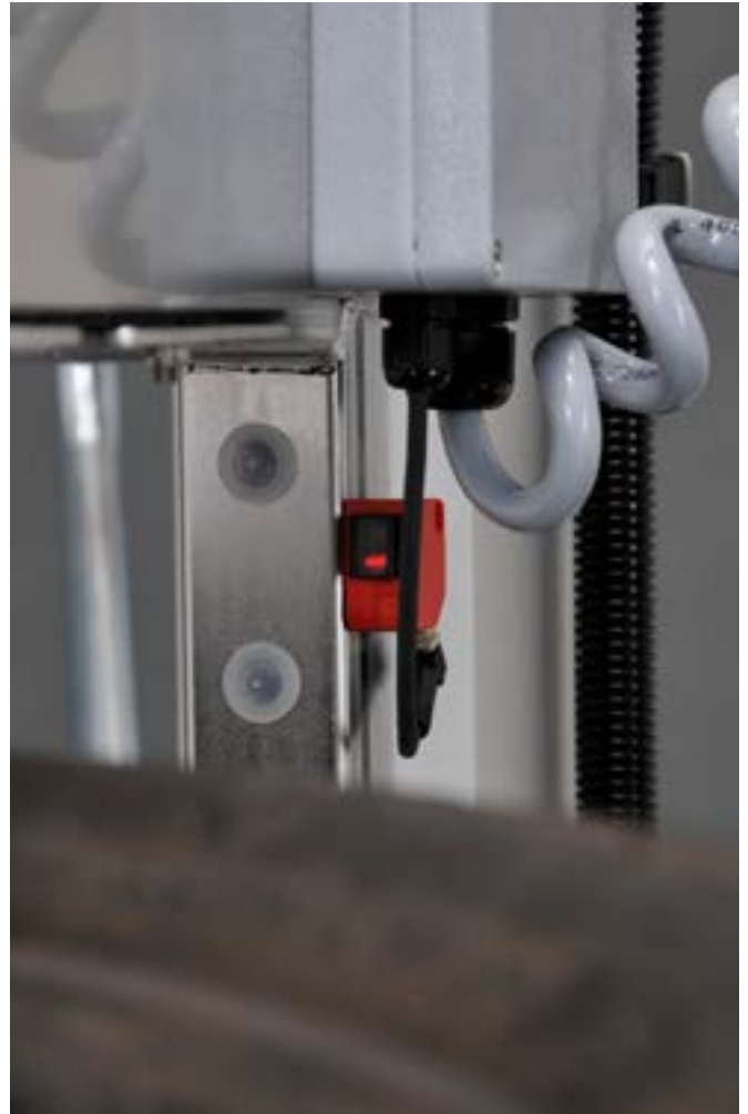
Reflexlichtschranke OR150175 zur Positionsabfrage der Hubachse. Vor dem Spannen wird die Hubachse so lange abgesenkt, bis der obere Rand des Reifenrohlings die Lichtschranke unterbricht. Dann haben auch die Innengreifer die korrekte Höhe erreicht.
