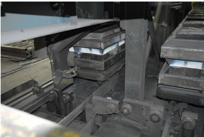
An dieser Position innerhalb des Bahnhofs muss der Sensor das Vorhandensein eines Gussbehälters detektieren.
