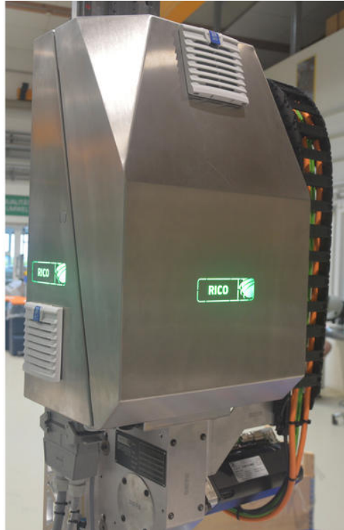
Un'idea insolita: RICO Elastomere Projecting indica lo stato della sua movimentazione di sfornatura cambiando il colore del logo aziendale. (Immagine: ipf electronic gmbh)
