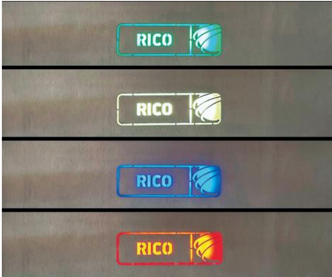
通过微标可显示四种处理状态：自动模式（绿色）、设置模式（黄色）、网络连接（蓝色）和故障（红色）。（图片：IPF electronic gmbh）
