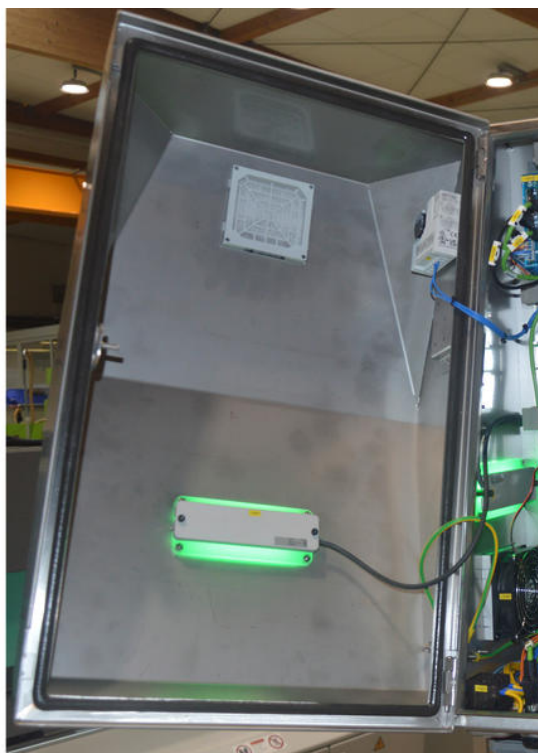
安装空间极小：多色 LED 信号灯安装在处理装置的门内和侧壁上 (右图)，此处安装在 eCO 转子上。(图片：IPF 电子公司)
