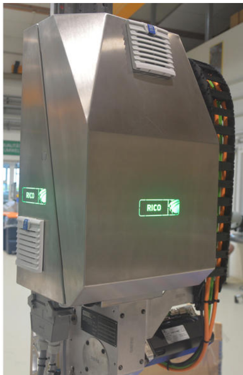
与众不同的创意：RICO Elastomere Projecting 公司通过改变公司标志的颜色来显示脱模处理的状态。(图片：IPF 电子公司)
