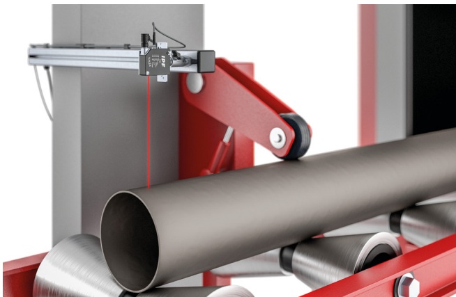
Mithilfe der Schleppzeigerfunktion lässt sich die Ovalität von Rohren mit einem spezifischen Durchmesser prüfen.
