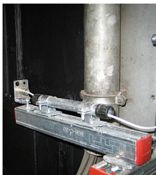
Detailní pohled na měřicí hlavu, která byla připevněna k přední části hliníkového profilu a kterou lze používat při teplotách okolí až +180 °C bez chlazení.
