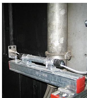
Detailaufnahme des Messkopfes, der auf dem vorderen Bereich eines Aluminiumprofils befestigt wurde und sich bei Umgebungstemperaturen von bis zu +180°C ohne Kühlung einsetzen lässt.
