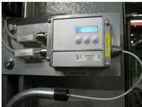
La unidad de evaluación independiente se conecta al sensor mediante un cable e integra una pantalla LCD iluminada con botones de fácil acceso para la programación.
