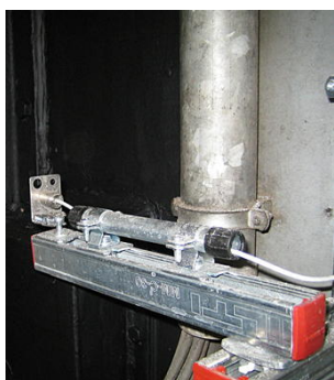
Détail de la tête de mesure fixée sur la partie avant d'un profilé en aluminium et pouvant être utilisée à des températures ambiantes allant jusqu'à +180°C sans refroidissement.
