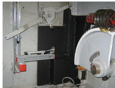
Poiché su ciascun lato della tramoggia si generano temperature diverse, è stato installato un sensore a infrarossi su ciascun lato della tramoggia (qui a sinistra) a scopo di monitoraggio.
