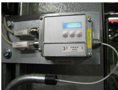
Oddzielna jednostka oceniająca jest podłączona do czujnika za pomocą kabla i zawiera podświetlany wyświetlacz LCD z łatwo dostępnymi przyciskami do programowania.
