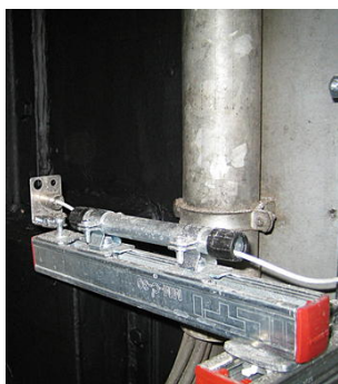
Zbliżenie głowicy pomiarowej, która została przymocowana do przedniej części profilu aluminiowego i może być używana w temperaturach otoczenia do +180°C bez chłodzenia.
