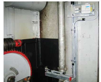
A cabeça de medição por infravermelhos do sistema de sensores montado num perfil OI98A920 com proteção IP65 é uma das mais pequenas do mundo (imagem central, em baixo) e mede a temperatura da parede na tremonha de alimentação a uma distância de 300 mm com uma resolução de 22:1.
