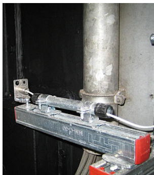
测量头特写，该测量头安装在铝型材的前部，无需冷却即可在高达 +180°C 的环境温度下使用。
