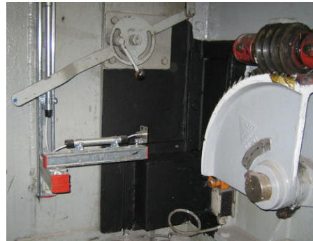
由于进料斗两侧产生的温度不同，因此在进料斗两侧各安装了一个红外线传感器（此处位于左侧），用于监测。
