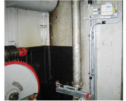
安装在型材上的传感器系统红外测量头 OI98A920 是世界上最小的传感器之一（下图中心），可测量进料斗处 300 毫米距离墙壁的温度，分辨率为 22:1。
