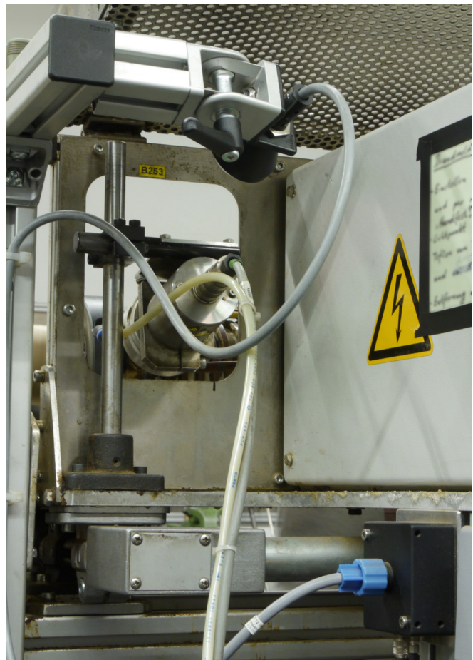
Při zapojení u automobilového dodavatele přenáší signály ze senzoru (vpravo dole) na reflexní optiku (nahore uprostřed) světelný vodič.
