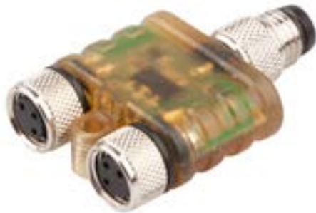
Statt interner Verdrahtung übernimmt die integrierte Elektronik des VL150102 die UND-Verknüpfung der Sensorausgänge, sodass stets „saubere“ Signale an der Steuerung anliegen. (Bild: ipf electronic)
