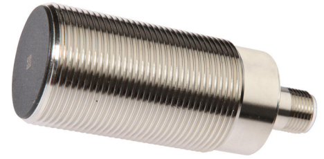
Der induktive Sensor IA30012W im robusten Metallgehäuse mit integriertem Verstärker ist für einen Temperaturbereich von -40° C bis +100° C ausgelegt.
