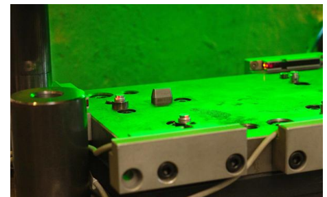
Barva světla signálního světla se změní na "zelenou", jakmile světlo obdrží signály logické operace AND z optických senzorů. Všechny šrouby jsou pak přítomny v nástroji a lze je zatlačit do součásti.
