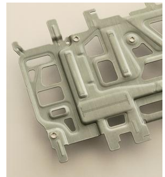
Zleva: Zleva nahoře a dole součástka, do které byly zalisovány šrouby pro uchycení desky s plošnými spoji.
