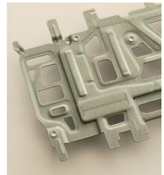
Von links: Unter- und Oberseite des Bauteils, in dem die Stehbolzen zur Aufnahme einer Leiterplatte eingepresst wurden.
