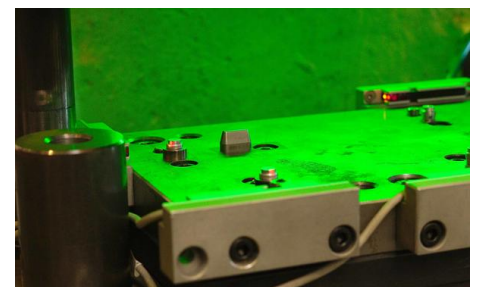
El color de la luz de señalización cambia a "verde" en cuanto la luz recibe las señales Y lógicamente enlazadas de los sensores ópticos. A continuación, todos los pernos están presentes en el molde y pueden introducirse a presión en el componente.
