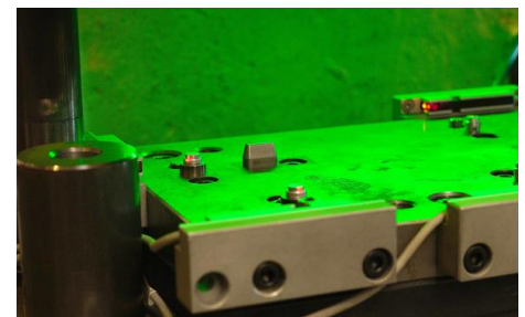
La couleur de la lampe de signalisation passe au "vert" dès que la lampe reçoit les signaux ET logiquement liés des capteurs optiques. Tous les boulons sont alors présents dans l'outil et peuvent être enfoncés dans la pièce.
