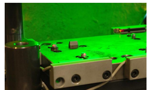
Il colore della luce di segnalazione diventa "verde" non appena la luce riceve i segnali AND logicamente collegati dai sensori ottici. Tutti i bulloni sono quindi presenti nello stampo e possono essere pressati nel componente.
