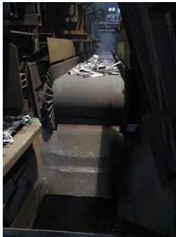
Das Transportband im Bereich des Abwurfschachtes (hier aus zwei unterschiedlichen Perspektiven). Die Aufnahmen machen deutlich, dass hier sehr raue Einsatzbedingungen vorherrschen.
