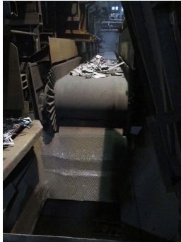
La cinta transportadora en la zona del canal de descarga (aquí desde dos perspectivas diferentes). Las imágenes muestran claramente que las condiciones de funcionamiento aquí son muy duras.
